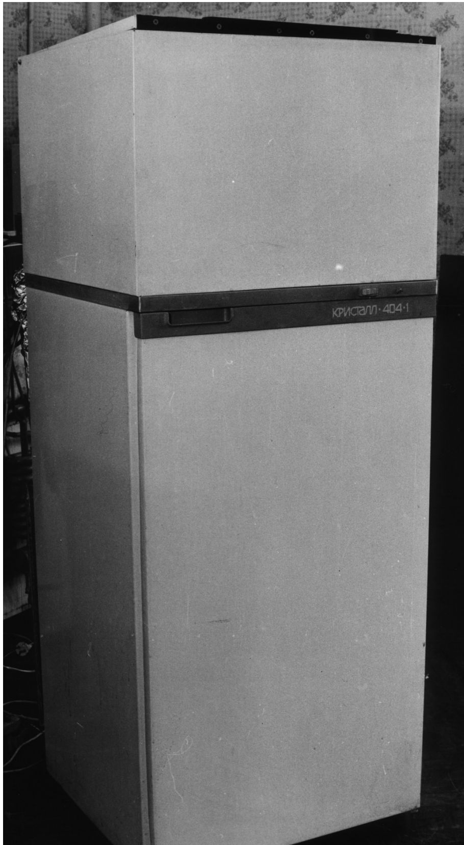
Рис.2.1 Зовнішній вигляд (вигляд спереду) комбінованого абсорбційного холодильника з тепловою камерою на базі серійної моделі побутового однокамерного абсорбційного холодильника типу «Кристал-408» АШ-150
