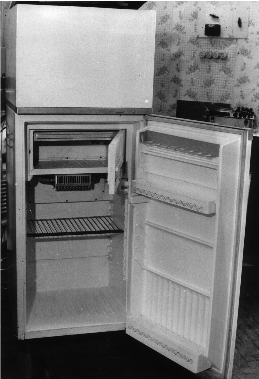
Рис.2.2 Зовнішній вигляд (вигляд спереду, відкриті двері холодильної камери та низькотемпературного відділення) комбінованого абсорбційного холодильника з тепловою камерою на базі серійної моделі побутового однокамерного абсорбційного холодильника типу «Кристал-408» АШ-150
