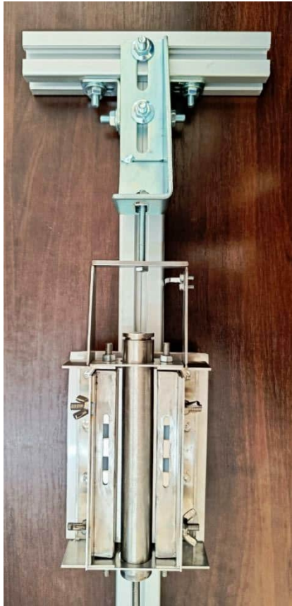
Рисунок 3.18 – Пристрій для визначення зусилля зчеплення, оснащений імітатором зовнішнього супорту для швидкої заміни магнітів
