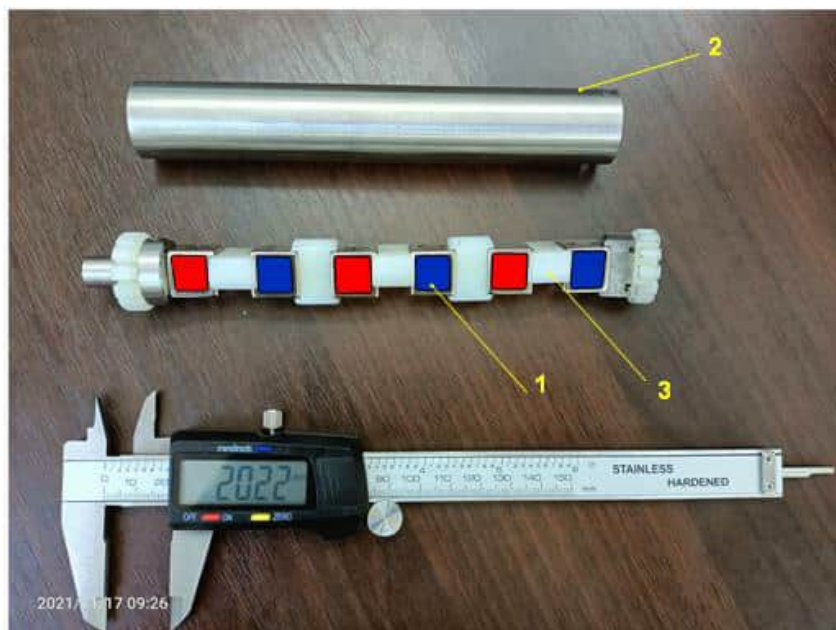
Рисунок 3.10 – Пристрій внутрішнього блоку магнітів: 1 – магніт внутрішнього блоку; 2 – гільза внутрішнього блоку магнітів; 3 – центруючі дистанцери
