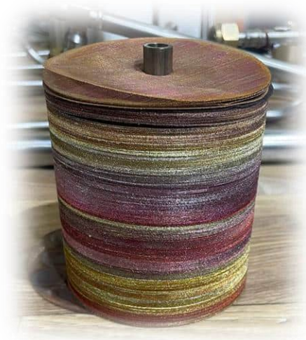
Рисунок В11 – Насадочна частина регенератора
