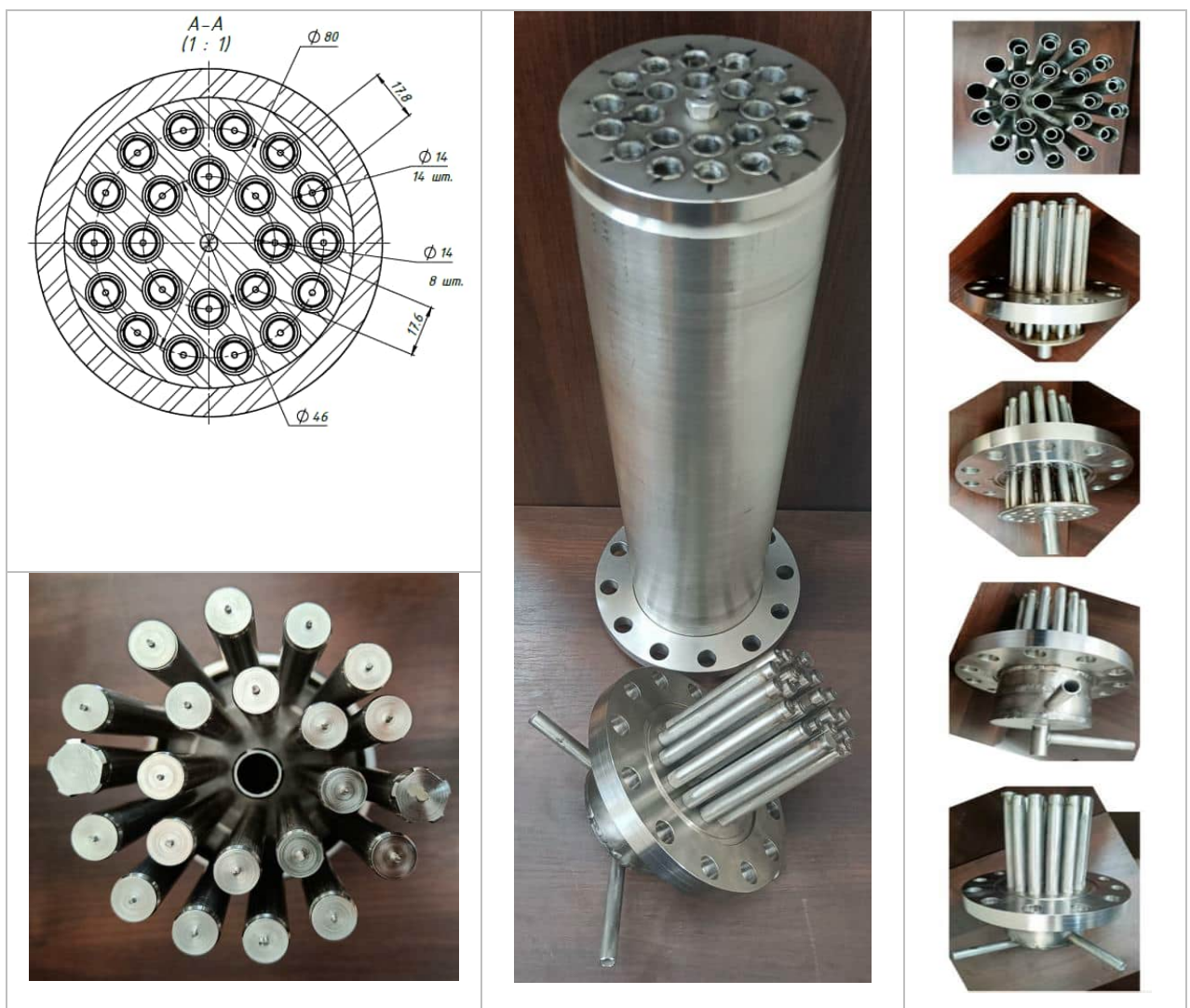
Рисунок 2.9 – Поперечний перетин циліндра в зоні охолоджувача (див. рис. 2.8), загальний вигляд вузлів охолоджувача 3 і його колекторів (5-6). На правому фрагменті показана послідовність складання охолоджувача
