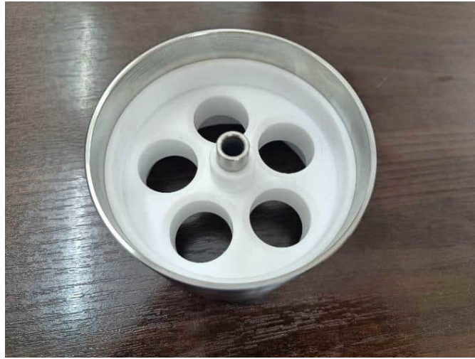
Рисунок Д3 – Деталь-замінник регенератора для дослідження опору сітчастого шару регенератора
