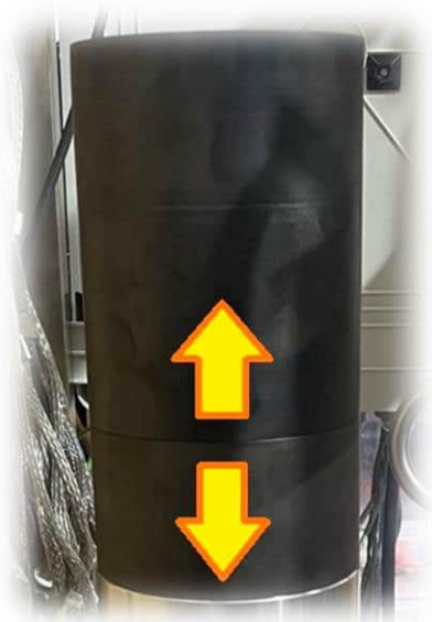
Рисунок В9 – Демонтаж верхньої секції витіснювача
