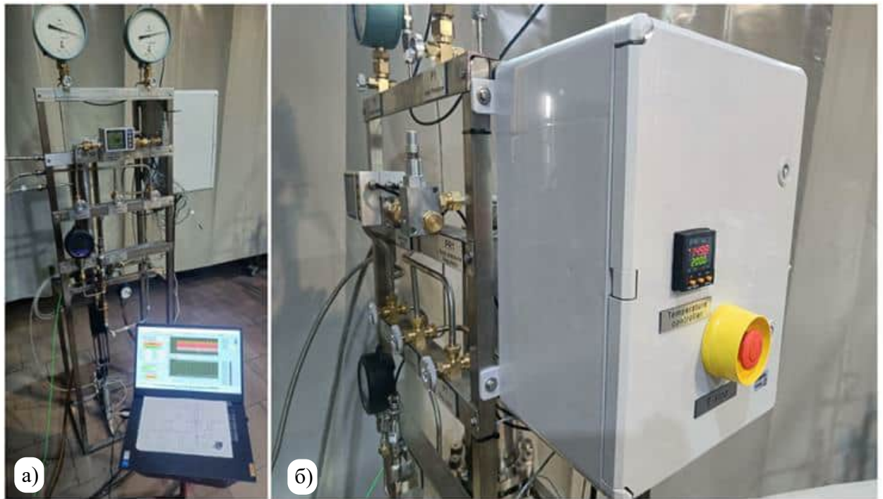
Рисунок 3.27 – Окремі вузли стану для випробувань макетного зразка пневмонагнітача: (а) – загальний вигляд; (б) – щит управління та захисту
