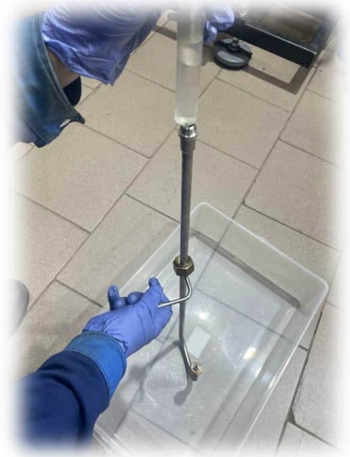
Рисунок В14 – Промивання з'єднувальних трубопроводів
