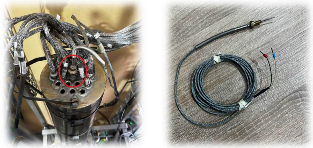
Рисунок В4 – Демонтаж термопар
