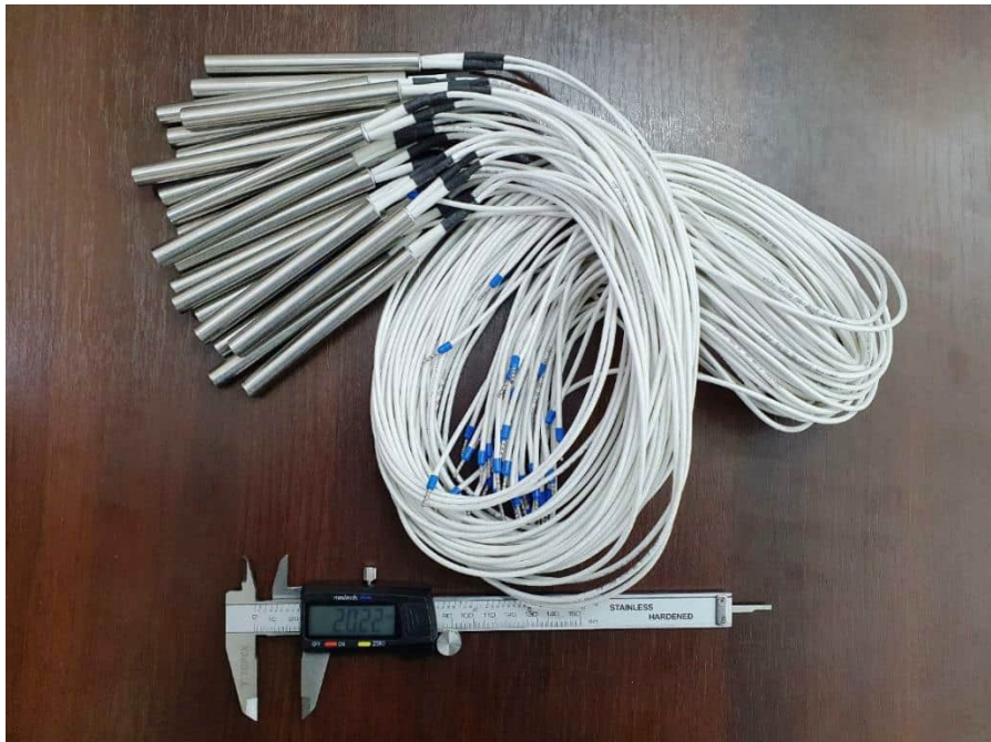
Рисунок 3.23 – Електричні нагрівачі з вбудованими датчиками температури, що використовуються як імітатор гріючого середовища
