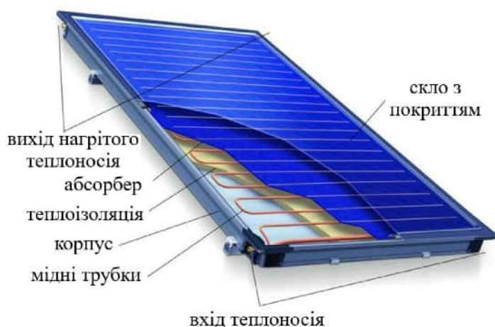
Рис.5.1. Принципова схема плоского сонячного колектора [95]
