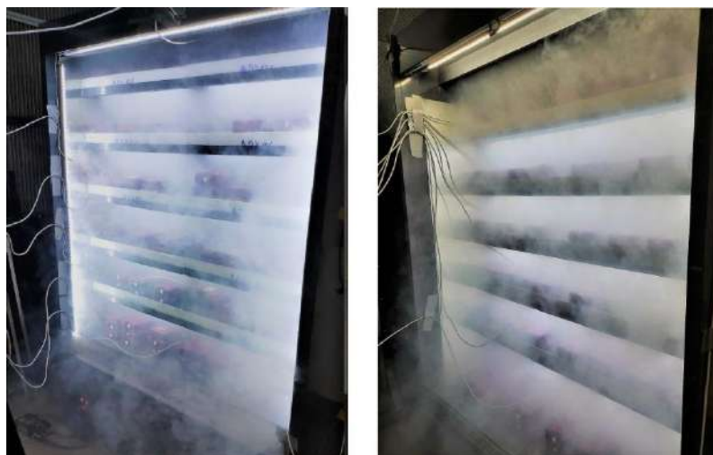
Рис.2. Дослідження руху повітря та рециркуляції в охолоджуваному об'ємі пристінних холодильних вітрин.
