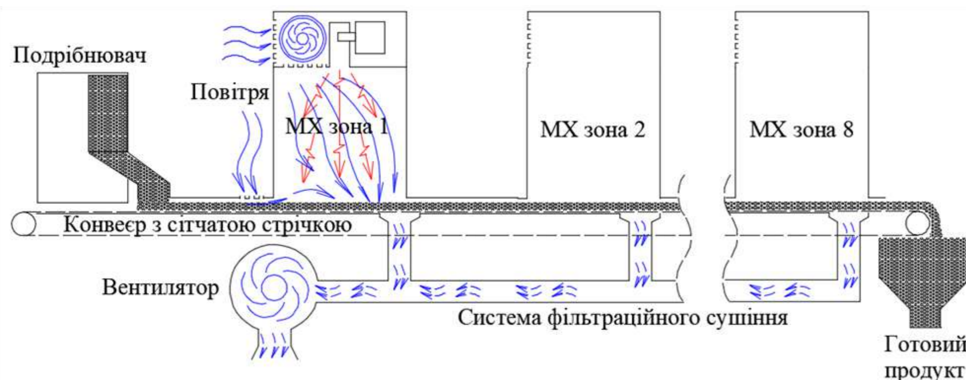
Рис. 1 Варіант конструкції МХ сушарки для шкірок цитрусових
