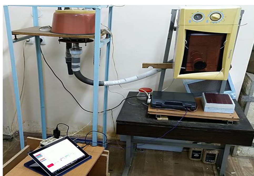
Рис.2. Дослідний стенд з комбінованим способом вологовидалення.
