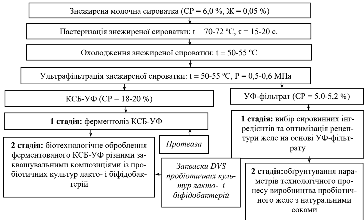
Рис. 1 – Принципова схема комплексного перероблення молочної сироватки у продукти преміум-класу
