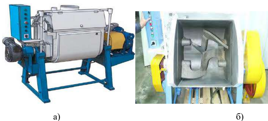
а – загальний вигляд з боку; б – вигляд тістомісильного корита з лопатями
