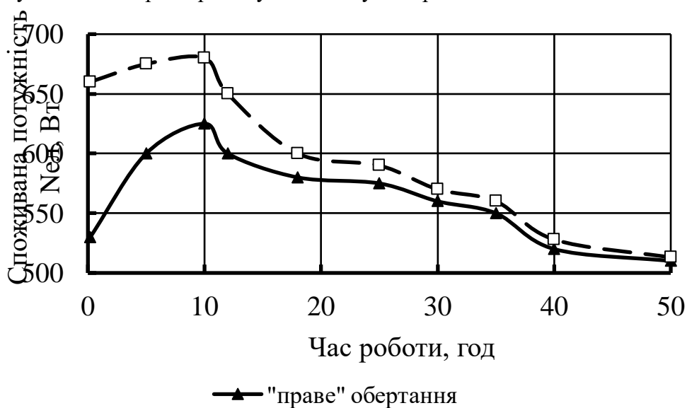
Рис. – Зміна потужності N_{ел} при випробуваннях компресорів в умовах реверсу механізму руху
