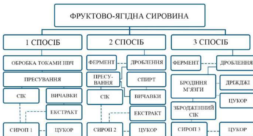
Рис. 1 – Функціональна схема виробництва фруктових сиропів
