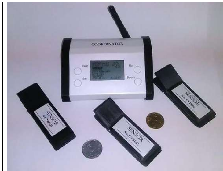
Рис. 3. Дослідний взірець бездротової сенсорної мережі
