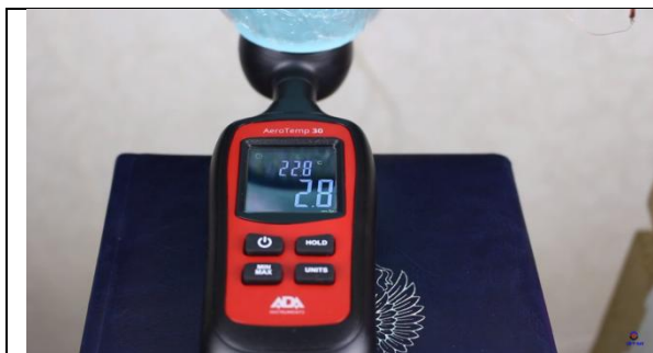
Рис. 2. Швидкість повітря в 3х секційному «Іонному вентиляторі».
