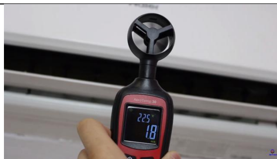
Рис. 3. Швидкість повітря в пристіному блоці кондиціонера.
