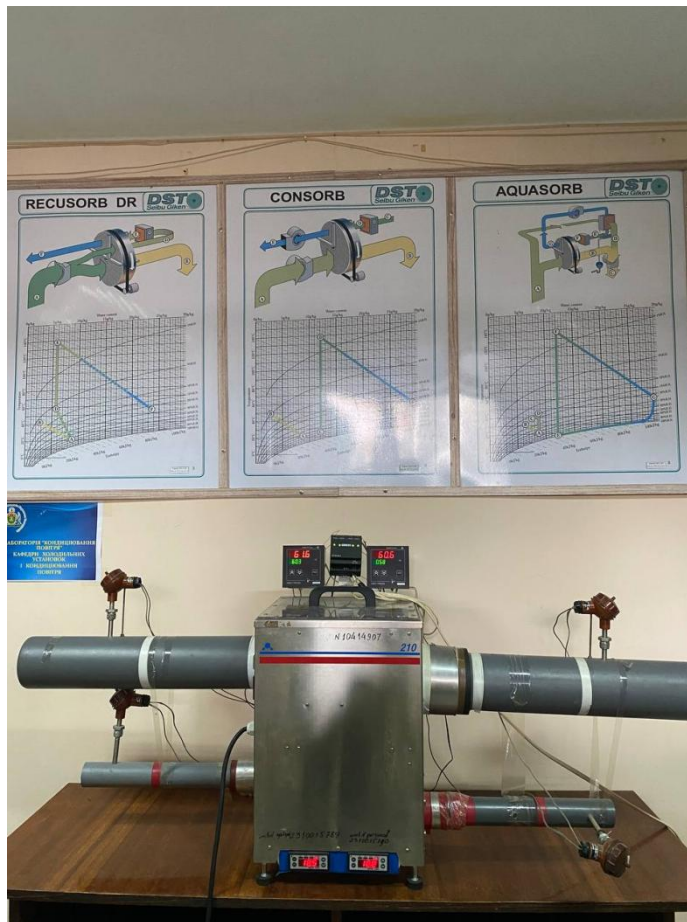
• Рис.2 Експериментальна установка роторного осушувача лабораторія 016 ОНТУ
