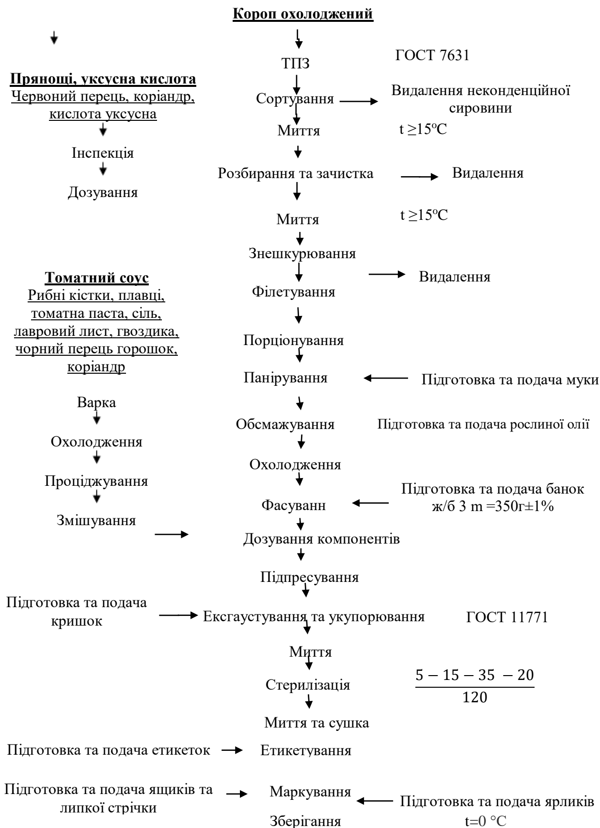
Рис. 2 – Технологічна схема виробництва консервів «Короп по-одеські»
