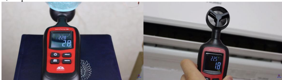
Рис.3 Швидкість повітря в 3х секційному «Іонному вентиляторі».
