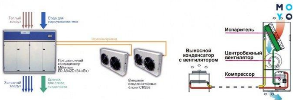
Рис.1. Схема прецизійного кондиціонера
