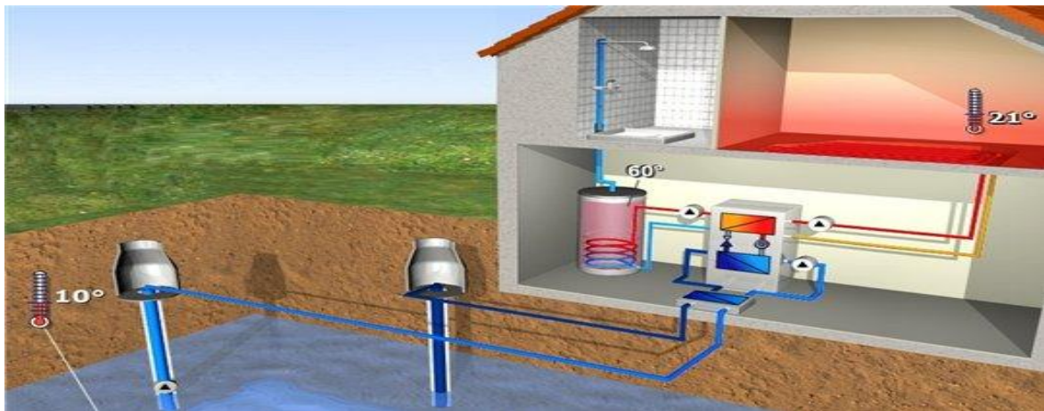
Рис. 1. Схема теплового насоса типу «вода-вода».
