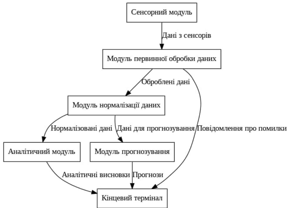
Рис. 1 – Ієрархія функціональних модулів бортового комп'ютера
