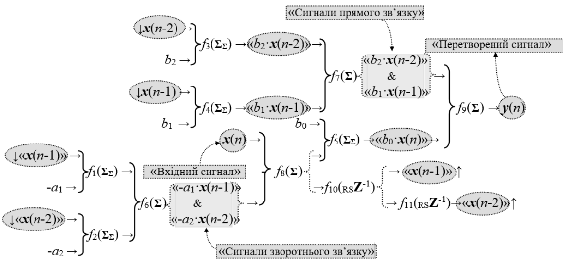
Рисунок 2 – Структура цифрового смугового фільтра для обробки сигналу з датчика
