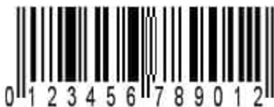
рис. 1. Структура штрихкової позначки EAN-13*
